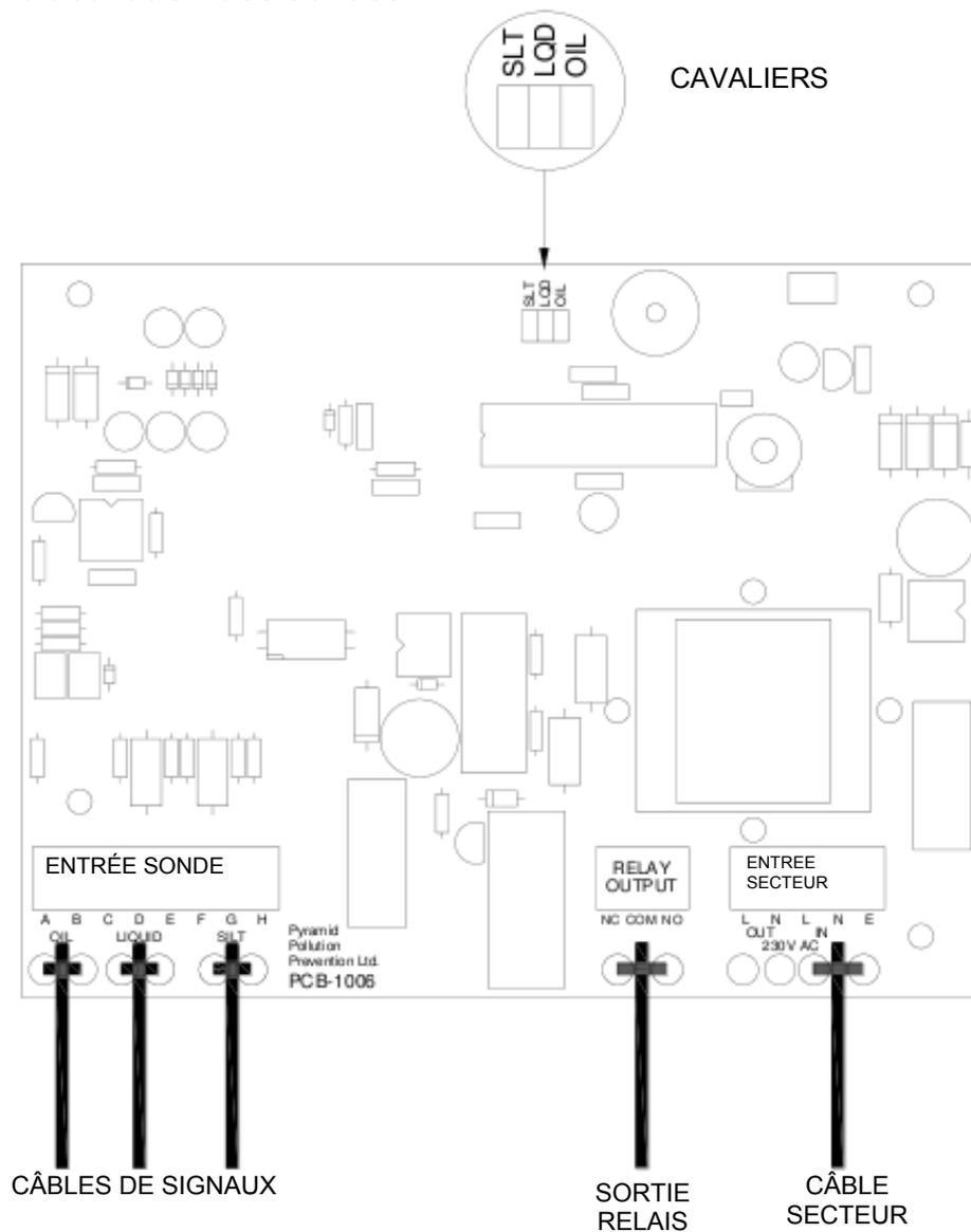
Figure 1 - Cavaliers d'activation des sondes
