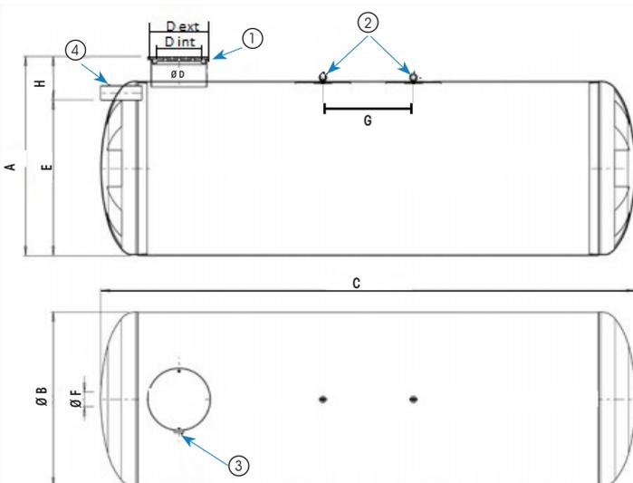
1 - Trou d'homme diamètre extérieur 770 mm et diamètre intérieur 615 mm, équipé d'un couvercle à visser
