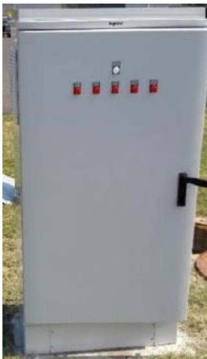
Fourniture d'un coffret polyester fermé IP54 de dimension H800xL600xP300 incluant l'appareillage et le compresseur avec 2 grilles ventilation, fermeture avec poignée insert double barre.
